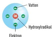
nanoe™ är elektrostatiskt laddade finfördelade vattenpartiklar med gott om hydroxylradikaler.
